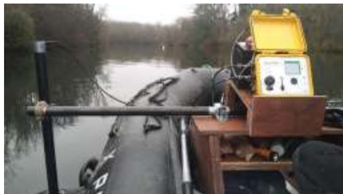
Figure 8 : Suivi acoustique par hydrophone fixe (à gauche) et mobile à l'aide d'hydrophones embarqués (à droite) (source : FDAAPPMA 10)
